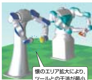
作業エリアを最大化するために、懐部分が大きくとれるボディ形状です。
