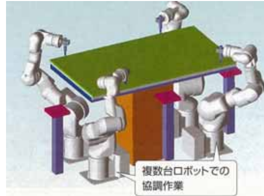
7軸単腕ロボット高密度配置による組立て
