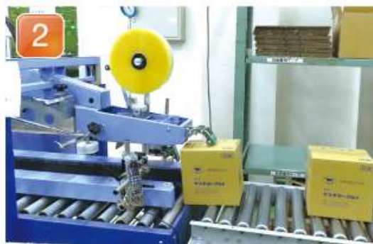
2 箱の封をする機構を通過して ロボットの前に運ばれます。
