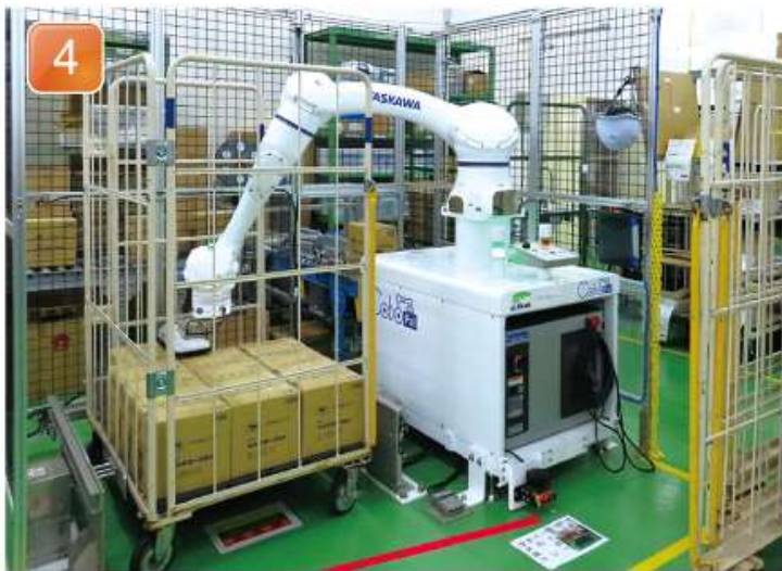
4 かご車の種類に合わせ、最適な位置で 段ボールを積み上げます。
