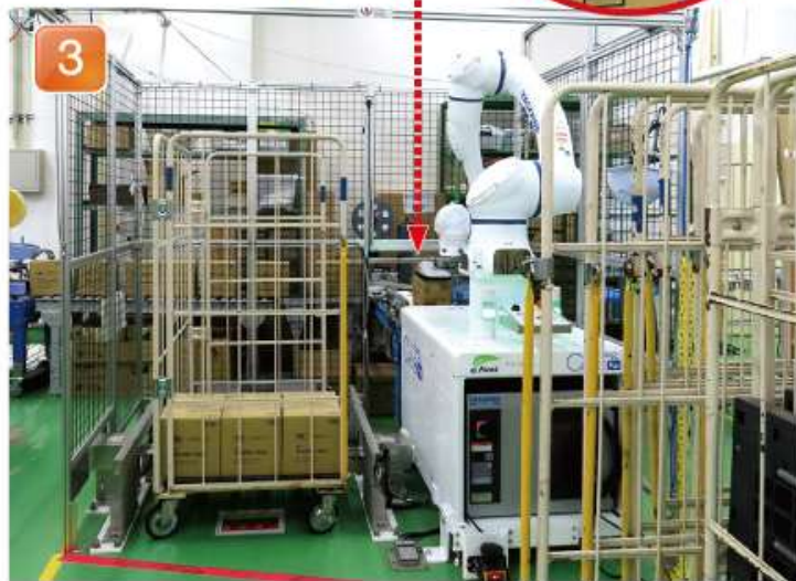
3 ロボットが段ボールを吸着し持ち上げます。
