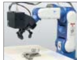
三次元計測ユニットを ロボットに搭載した例
